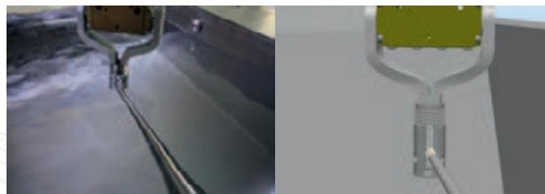
In Ihrem digitalen Zwilling können Sie den Fertigungsprozess optimal vorsimulieren und überwachen. Kollisionen gehören der Vergangenheit an. Mit maximal 3 Einstellteilen können Sie fast jede Bauteilgeometrie entgraten.
